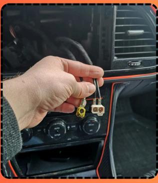
Nur das Weiße Kabel für die Antenne wird benötigt.
